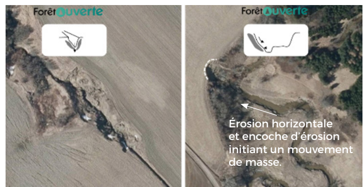
Figure 3.2 Exemples de processus d'érosion dans les coulées agricoles en fonction de leur localisation dans le bassin versant (gauche : amont; droite : aval).
